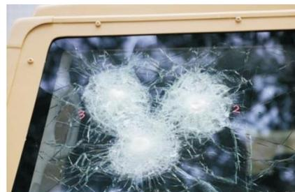
注：玻璃增加电磁屏蔽和雷达隐身效果，不影响防弹性能及厚度。
